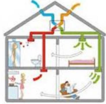
Les bouches d'entrée et d'extraction de l'air sont placées soit au sol, soit aux murs soit aux plafonds des différentes pièces, suivant les indications du fabricant, de l'étude technique spécifique et des contraintes techniques de l'immeuble. La prise d'air frais et le rejet de l'air vicié à l'extérieur, se feront soit en façade, soit en toiture, par conduits individuels par appartement ou par conduits collectifs, suivant possibilités et études techniques.
