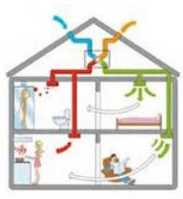
La prise d'air frais et le rejet de l'air vicié à l'extérieur, se feront soit en façade, soit en toiture, par conduits individuels par appartement ou par conduits collectifs, suivant possibilités et études techniques.
