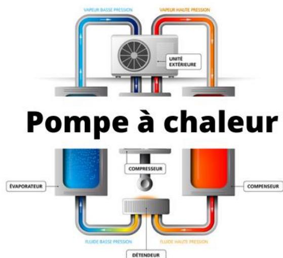
Le principe de fonctionnement est simple. La pompe à chaleur air eau puise les calories présentes dans l'air pour les redistribuer sous forme de chaleur dans le circuit de chauffage central (radiateur basse température, plancher chauffant ou autre émetteur). Elle est capable de satisfaire vos besoins de chauffage et d'eau chaude sanitaire.
