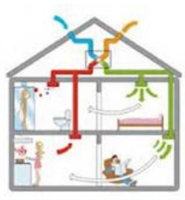
Les bouches d'entrée et d'extraction de l'air sont placées soit au sol, soit aux murs soit aux plafonds des différentes pièces, suivant les indications du fabricant, de l'étude technique spécifique et des contraintes techniques de l'immeuble. La prise d'air frais et le rejet de l'air vicié à l'extérieur, se feront soit en façade, soit en toiture, par conduits individuels par appartement ou par conduits collectifs, suivant possibilités et études techniques.
